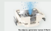
4 | Urządzenie nie wymaga serwisowania ani konserwacji. W generatorze nanoe™ X nie ma filtrów ani nie wymaga ono konserwacji, ponieważ proces wytwarzania rodników przez tytanową elektrodę przebiega w osłonie wody.
